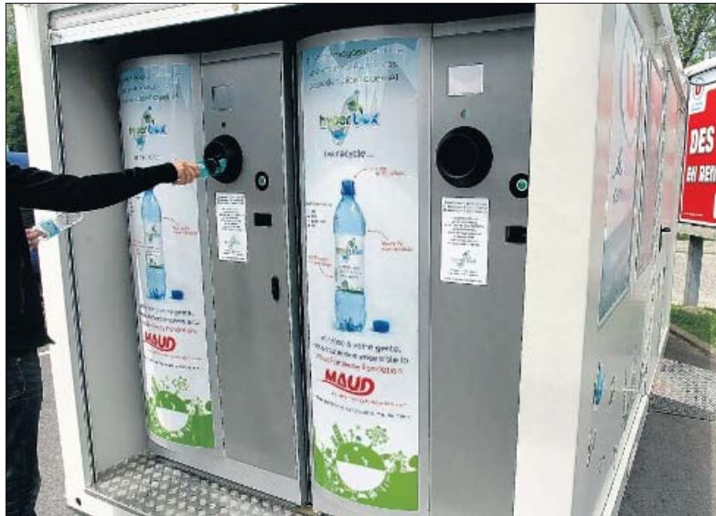
Grâce aux deux compacteurs intégrés, l'Hyperbox peut contenir entre 1 600 et 1 800 bouteilles. La Maud Fontenoy fondation est marraine de ce projet de consigne à bouteille plastique. Le DU/Sylvain MUSCO
